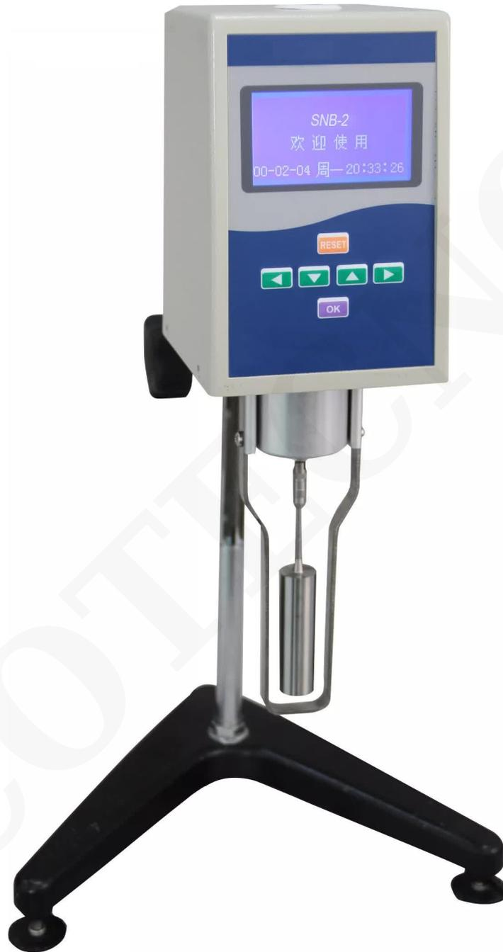
Este dispositivo adopta un avanzado diseño de máquina, tecnología de fabricación y tecnología de control por microordenador. La luz azul Ken y la pantalla LCD de alto brillo se seleccionan para la correcta visualización de adquisición de datos, y la visualización de datos es clara.
