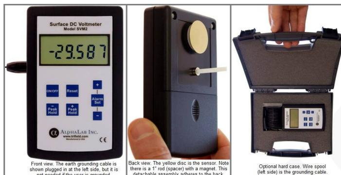
Un medidor electrostático, el SVM2 lee electricidad estática sin contacto. Mide el voltaje en superficies conductoras y se puede usar para calcular la densidad de carga en aisladores. Tiene una retención máxima positiva y negativa, una alarma rápida configurable por el usuario y una resolución muy alta de 1 voltio en un rango de 30K voltios.
