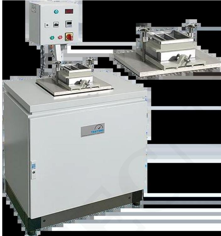
Necesario para la compactación de muestras de 40 x 40 x 160 mm para la norma EN 196-1. Se puede pedir con un accesorio de abrazadera de acción rápida o un accesorio de abrazadera de uso general para (1) molde de 3 elementos para muestras de 40 x 40 x 160 mm. La placa vibratoria tiene un tamaño de 400 x 300 mm y está integrada en un gabinete de acero con recubrimiento en polvo.
